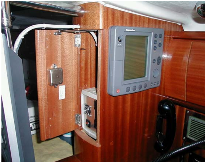
SeaCenter 3001 eingebaut in Konsole am Navitisch auf einer Bavaria 49 mit schwenkbaren 15" TFT
